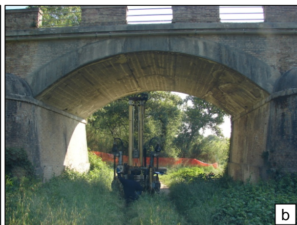
Sondaggio sul rilevato stradale in destra idrografica (a) e prova penetrometrica sul piano d'appoggio delle pile del ponte in sinistra idrografica (b).
